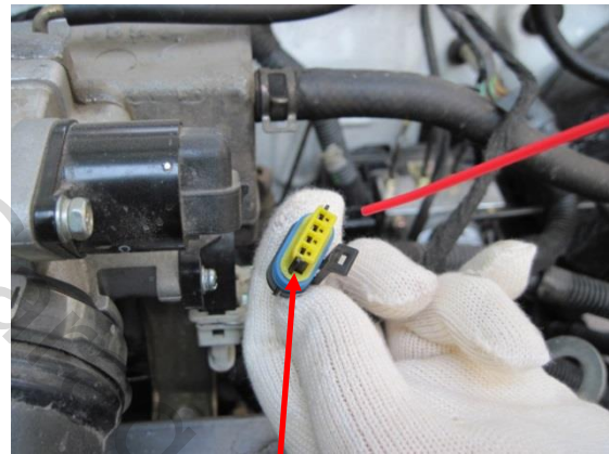
اسپری کردن کانکتورهای دسته سیم استپر موتور
